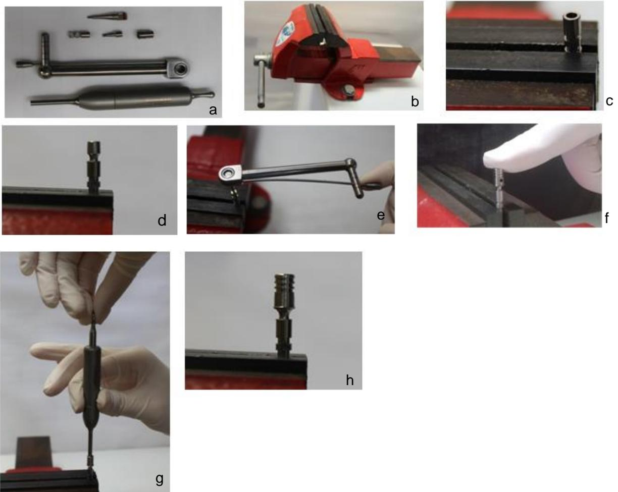
Legenda: a) conjunto para montar o corpo de prova; b) morsa; c) análogo fixado na morsa; d e e) pilar FF fixado no análogo com chave 1,2 e torquímetro manual aplicando 32N de torque; f) cilindro colocado sobre o pilar FF aperto inicial digital; g) aperto final com martelo aplicando três batidas; h) corpo de prova pronto.
